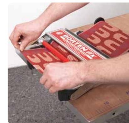
Das **BORTENfix** erlaubt das schnelle und saubere Einkleistem sämtlicher Borten. Der Zahnradantrieb sorgt für einen exakten Kleberauftrag.
