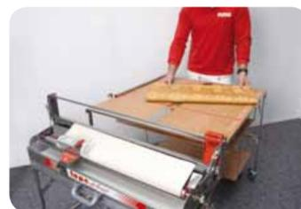
Bei **langen Bahnen über 3,00 m** wird ebenso wie bei den Standard-Raummaßbahnen begonnen: Also auf 1,70/1,80 m ausziehen, vor Kopf wechseln, nach vorne einlegen und umschlagen. Nun wird das nächste Stück bis Ende des Gerätetisches gezogen und ebenfalls nach vorne eingelegt. Hierbei werden nun die einzelnen Teile der Bahn wie eine Ziehharmonika – also in Schlaufen – auf den Tisch gelegt. Dies wird so oft wiederholt bis das Maß erreicht ist.
