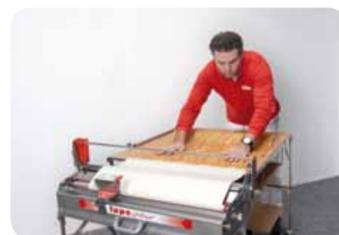
Bei **normalen Bahnen von 2,50 m bis 3,00 m** wird die Tapete zunächst auf eine Länge von ca. 1,70 m bis 1,80 m aus dem Gerät gezogen. Dabei wechselt man von der Seite des Gerätetisches vor Kopf und legt die Bahn folglich nach vorne zum Kleistertisch hin zusammen, was vor allem bei breiten Bahnen eine echte Arbeitserleichterung ist. Anschließend wird das Restmaß hinterhergezogen, abgeschnitten und zusammengelegt. Bei Mustertapeten muss die Tabelle im Kleistergerät beachtet werden.
